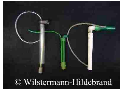
Zwei Luftheber aus dem Handel, der Linke mit Sprudelstein und ganz rechts ein Selbstgebauter.
