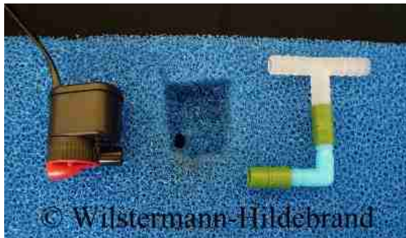
Pumpe und Verlängerung des Ausströmstutzens
