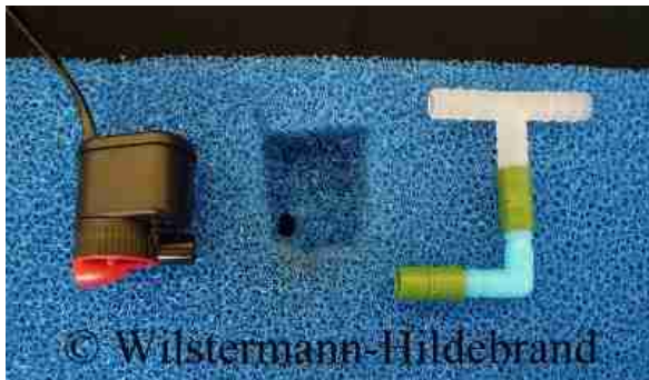
Pumpe und Verlängerung des Ausströmstutzens
